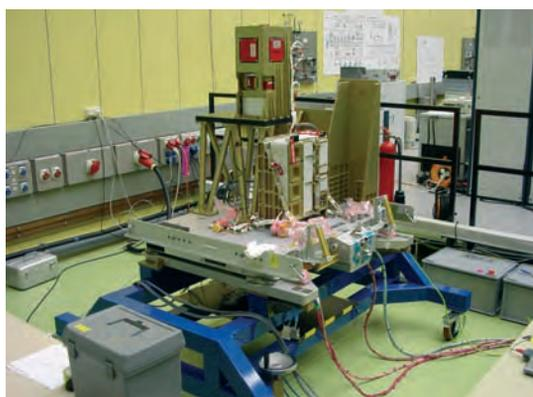
Tests d'interface des trois premières expériences à intégrer sur le modèle de vol de l'EuTEF
