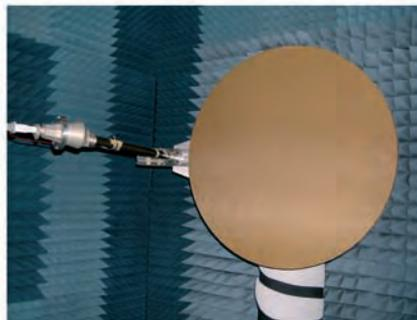
Caractéristiques géométriques de l'antenne à réseau réflecteur brevetée et maquette sur table. Il est possible de régler les dimensions des éléments imprimés rectangulaires pour obtenir le déphasage souhaité pour chaque faisceau à différentes fréquences de la bande de fonctionnement
