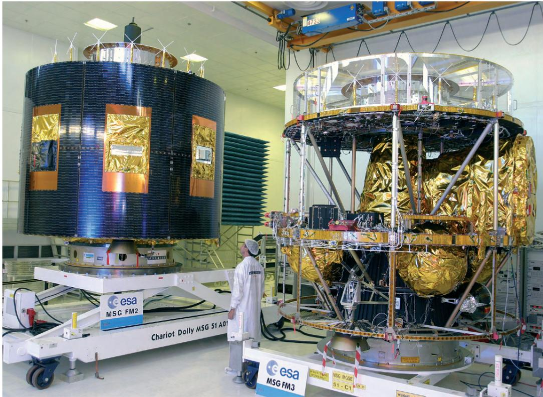
MSG-2 en configuration de vol et MSG-3 sous forme pré-intégrée dans la salle blanche d'Alcatel Space à Cannes (F)
