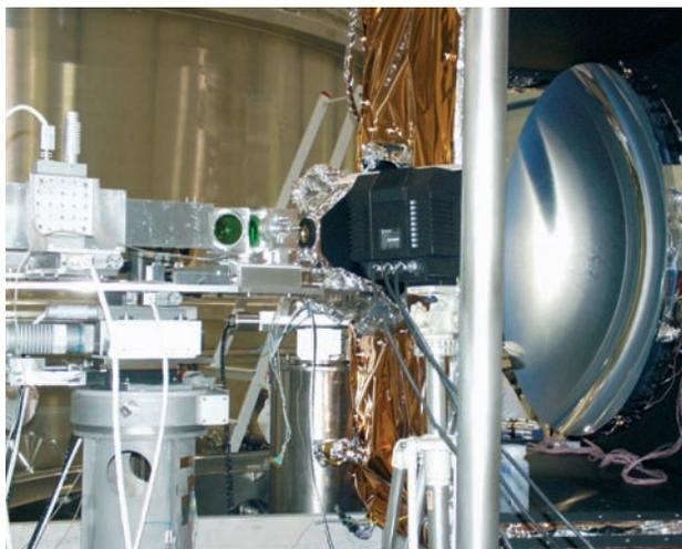
Essais du Réflecteur renforcé de fibres de carbone du satellite Planck de l'ESA au Centre spatial de Liège (CSL)
