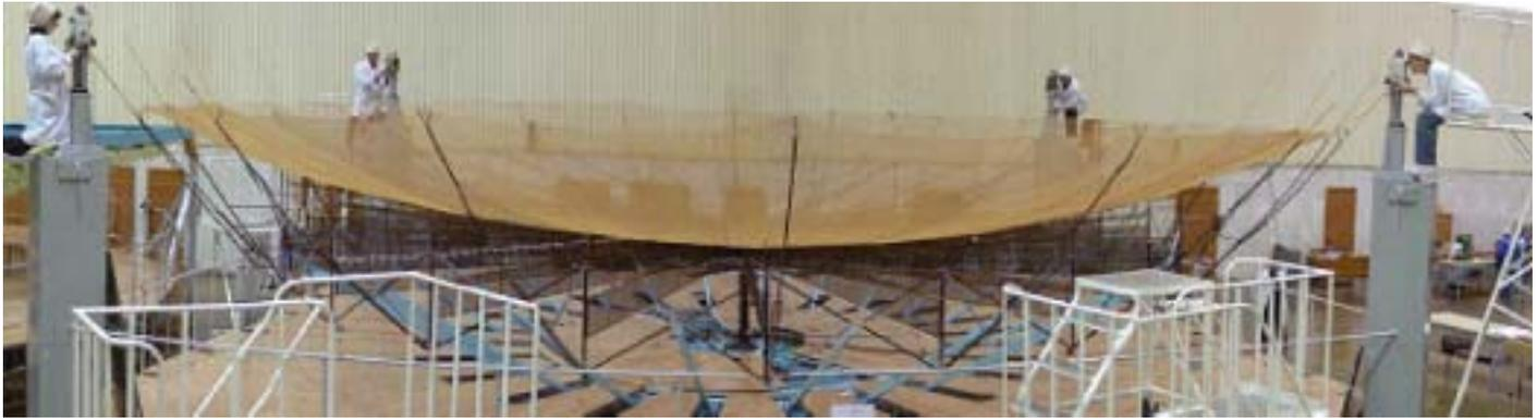
Réalisation de mesures de la précision de la surface du réflecteur sur une grande antenne déployable (Source : NPO-EGS, RSC Energia et Alcatel Alenia Space Italie)
