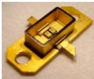
Technologie large bande : ensemble doté de deux transistors hyperfréquence à haute efficacité et haut gain, mesurant 12 x 125 microns et branchés en parallèle
