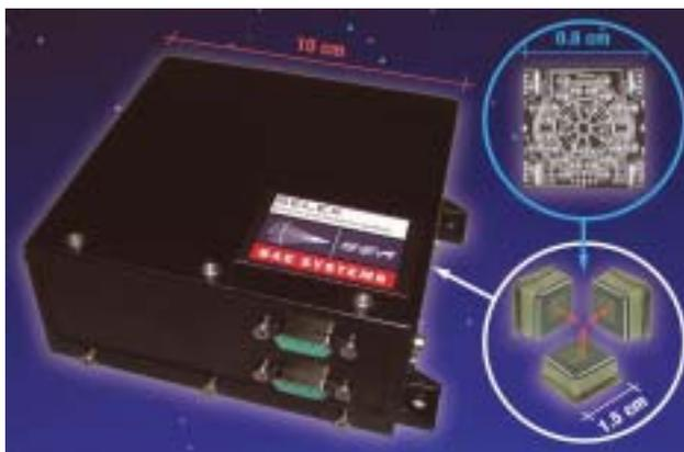
Détecteur de vitesse angulaire européen utilisant des MEMS, de masse réduite et de faible coût
