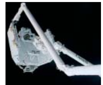
Système d'entretien mobile de l'ISS
